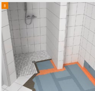
Bij integratie van de Powerpanel Inloopdouche elementen wordt ook ter plaatse van de elementovergang (Inloopdouche element - vloerelement) het afdichtingssysteem aangebracht.
